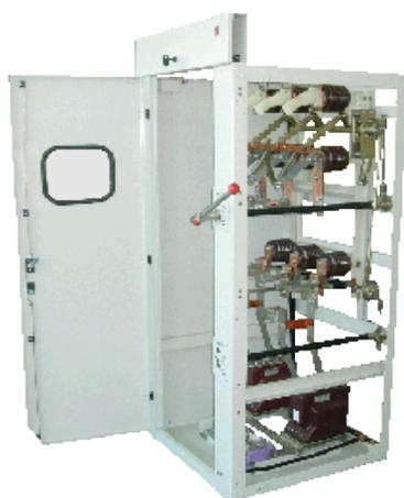
Комплектное распределительное устройство, состоящее из камер сборных одностороннего обслуживания КСО-306, предназначено для приема и распределения электрической энергии переменного трехфазного тока частотой 50 Гц напряжением 6 (10) кВ с изолированной нейтралью.
